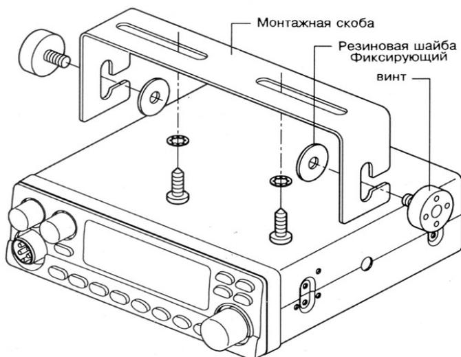
Рис. 1. Крепление радиостанции при помощи монтажной скобы.
