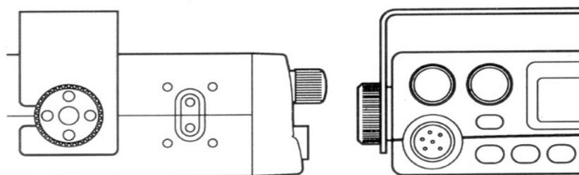
Рис. 2. Крепление радиостанции фиксаторами.
